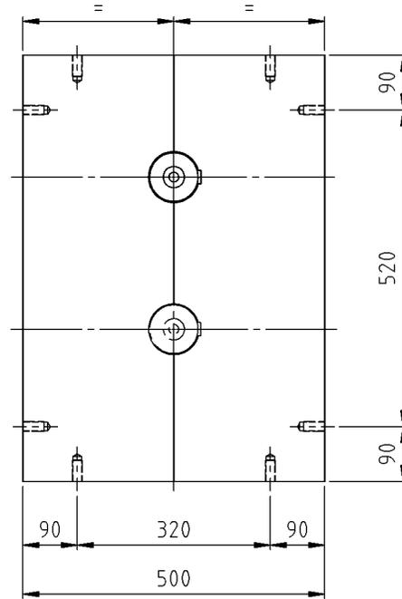
Ausführung (einseitig, beidseitig) und Position (rechts, links) der Antriebs- und Abtriebswellen frei wählbar
